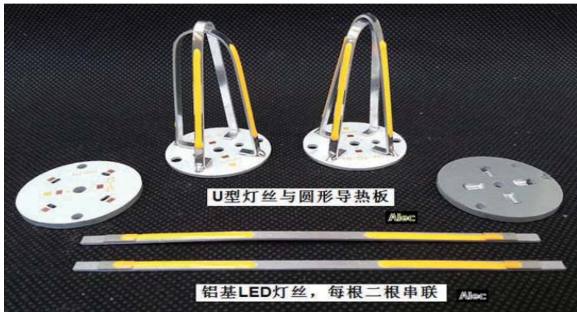
图3 LED 铝基灯丝、U型灯丝和铝质圆形导热板
