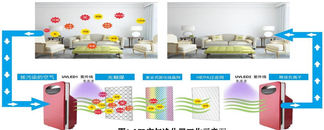
图1 LED空气净化器工作示意图
