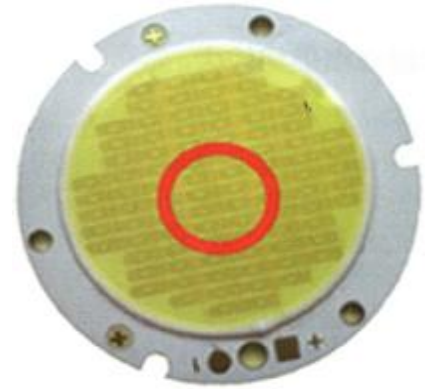
图2 COB中心管芯热量难散发
